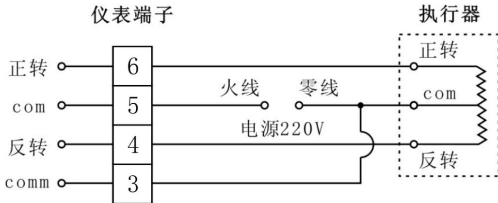
注：以上将调节阀的零线与本仪表的 3 号端子短接，可吸收调节阀动作时对仪表造成的干扰信号，此线如不接，本仪表也可正常工作。
