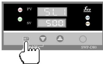
在 PV 显示测量值，SV显示控制目标值的状态下，按压 SET 键大于4秒，即进入参数设定状态。屏幕显示控制目标值参数符号SV及出厂预定值。
